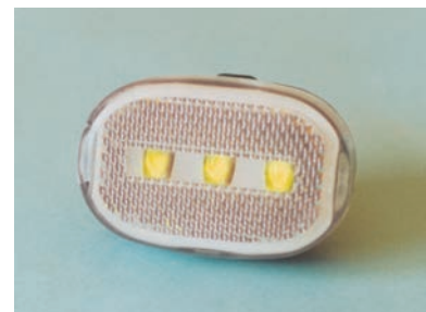
Fíor 25.1 Trí dhé-óid astaithe solais ar lampa rothair.
