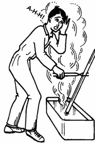
FÍOR 16 FAINIC AN GHAL A ÉIRÍONN Ó MHIOTAL TE AGUS É Á FHUARÚ
